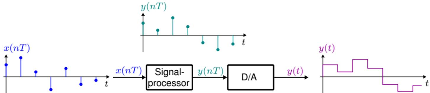
Da D/A konverterens udgangssignal er stykvis konstant med amplitude givet af amplituden for den digitale sekvens er her tale om et **nul'te ordens holdekredsløb**.
