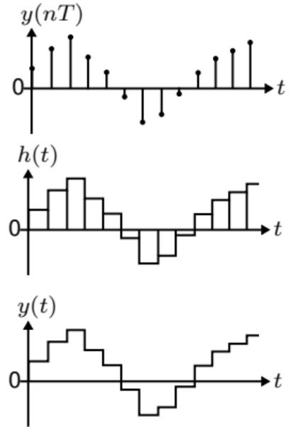
Bemærk at impulsresponset for holdekredsløbet er ligesom for en pulssampler, hvor  $\tau = T$  (dutyfaktor på 1).
