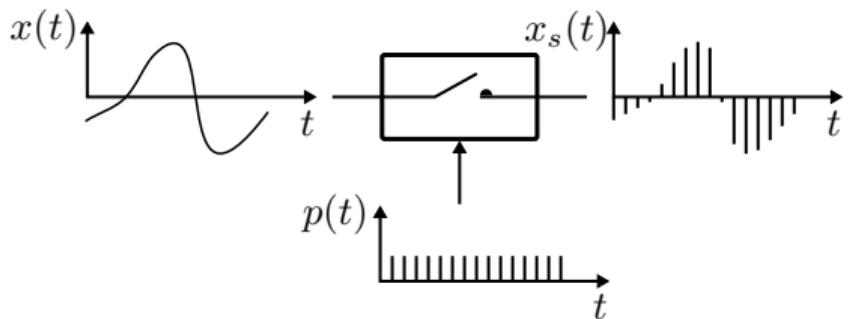
Sampleren karakteriseres ved dens **sampleinterval**  $T$  (tid imellem samples) eller **samplefrekvensen** givet som
