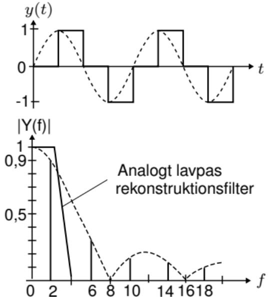
Følgende viser rekonstruktion af et 2 kHz sinussignal samplet ved 8 kHz.
