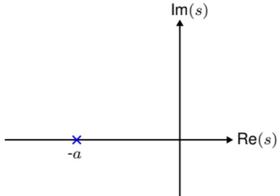
Den Laplacetransformerede af sekvensen  $x(nT) = e^{-anT}$  har poler  $s = -a \pm jn\omega_s$ .
