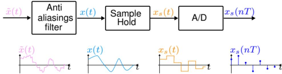
Når analoge signaler skal indlæses på en computer, er det nødvendig at analog-til-digital (AD) konvertere signalet.
