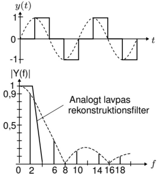
Der indsættes ofte et lavpasfilter efter D/A-konverteren for at dæmpe de højfrekvente komposanter ved  $f > f_o$ .
