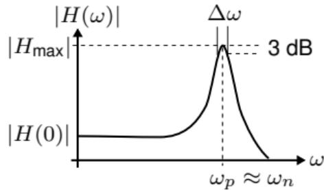
Dette filter kaldes en 2. ordens resonator, og er en simpel måde at realisere et båndpasfilter på.
